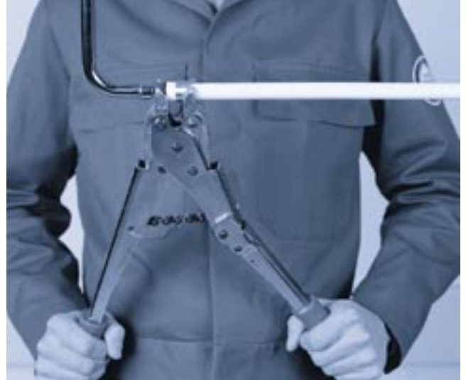
TECEflex -buis kan tot en met een diameter van 32 mm met een handtang worden geperst.
