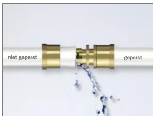
Niet geperste verbindingen zijn door de loszittende drukkuls direct herkenbaar. Bij het afpersen stroomt dan het water naar buiten.
