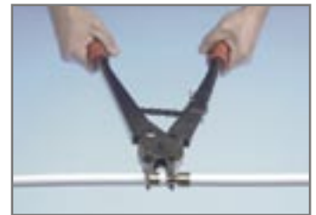
Persen van de verbinding met de handtang ...
